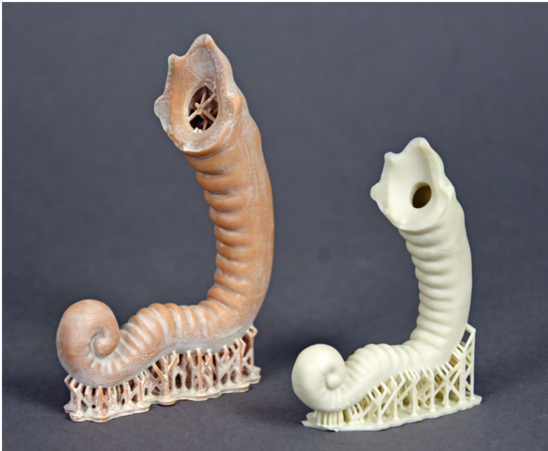
Links der sog. Grünkörper und daneben der fertig gebrannte, um das Schwundmaß verkleinerte Elefantenrüssel – jeweils mit der für den Druck notwendigen Stützkonstruktion.
