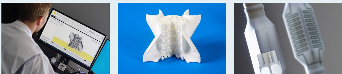
Abbildung 1: Druckjobvorbereitung eines Dreikammer-Fluidmischers (links), 3D-gedruckter Dreikammer-Fluidmischer mit unterschiedlichen Wandstärken und verdeckten Kanälen (Mitte), additiv gefertigter Fluidheizer mit aufgedruckten Leiterbahnen (rechts).
