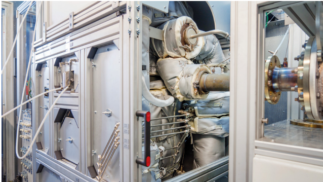
Heißgasfiltrationsprüfstand für Wabenfilter oder Filterkerzen.
