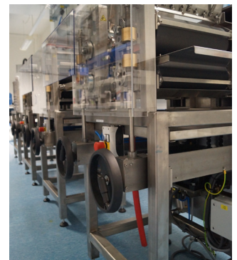
Gesamtansicht der kontinuierlichen Anlage für Schaumbeschichtung.
