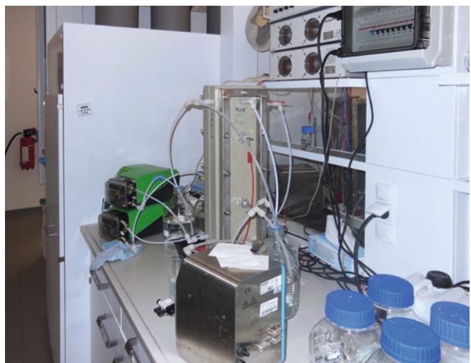
Bild 1: Bipolare Elektrodialyse zur Spaltung von Salzsole.
