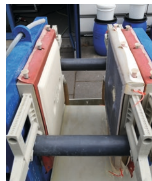
Bild 3: Abtrennung von Calciumphosphat aus Prozesswasser, Kammerfilterpresse mit Feststoffplatte.
