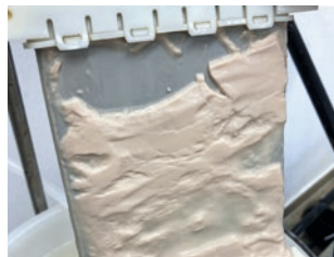
Bild 3: Mehrkanalplatte nach Filtrationsversuch mit Hefesuspension.
