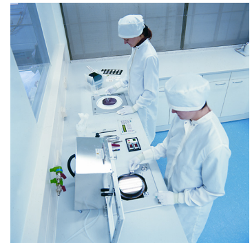
Spincoating im Reinraum.
