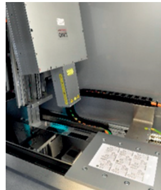
Diodenlaserlinie für Millisekundenbearbeitung.
