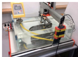
Bild 4: Kalibriertkörper Nr. 1 im Wasserbad eines automatisierten Messstands mit Thermostat zwischen zwei 20 MHz Ultraschallprüfköpfen (UT 1 und UT 2).
